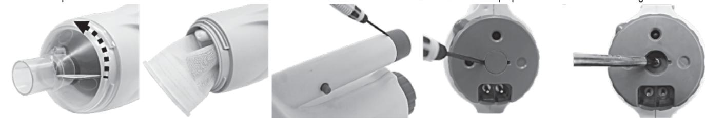
2. Détacher le bouton de commutation et utiliser le tournevis Philips pour dévisser toutes les vis sur le corps principal. Séparer le corps en deux moitiés pour accéder à la chambre principale
