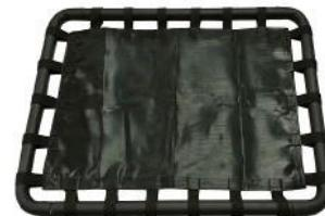
FR - Positionner les tubes droits en les emboitant dans les tubes en « U ». Attention au sens : Chaque tube dispose d'un embout étroit à mettre en face de l'embout large du tube sur lequel il va se connecter.
