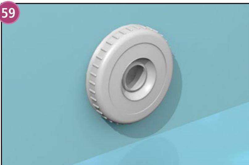
Vissez l'ensemble rotule orientable sur le corps du refoulement. La rotule devra être orientée vers la gauche pour favoriser un mouvement d'eau nécessaire au bon fonctionnement de la filtration.
