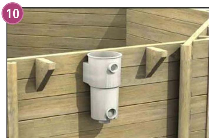
Les consoles au nombre de 2 sont positionnées à : 75,5 cm l'une de l'autre, de part et d'autre de l'axe du skimmer ou à 50 cm l'une de l'autre de l'axe de la filtration autonome. Si vous avez un coffre bois contre le structure pour protéger la filtration, vous n'aurez pas de consoles à positionner.
