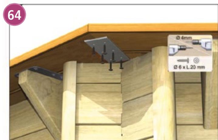
Il vous reste à fixer les 8 pièces de jonction d'angle (kit maintien présent dans le colis margelle) sous la margelle à l'aide de vis peinture. Positionnez la plaque en butée contre l'angle formé par les débords de lames.
