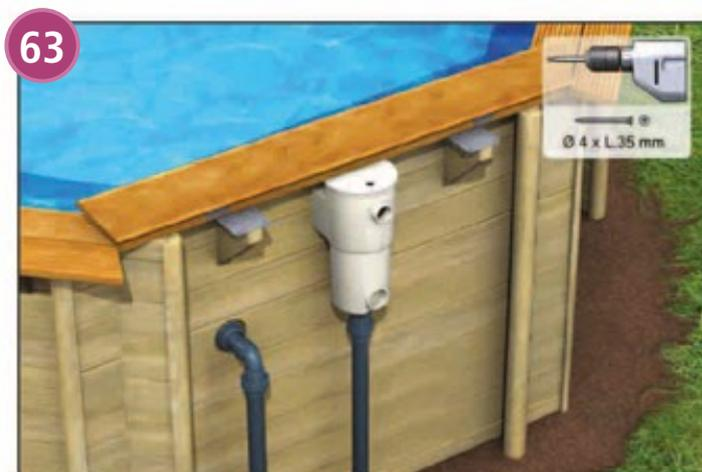
Dans le cas d'un skimmer, la planche extérieure au dessus du skimmer est solidarisée à la planche intérieure à l'aide de 2 charnières (sachet A). Elle n'est donc pas vissée sur les plaques de consoles. Cette articulation permet l'accès au panier de skimmer. Pensez après utilisation à verrouiller l'ouverture à l'aide des loquets (voir ci-dessous).
